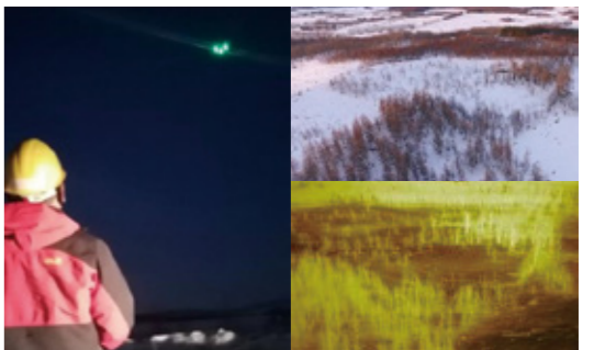
左:ドローン夜間飛行の様子 右:昼間飛行のドローン映像 右下:昼間に作成した3次元飛行データをもとに夜間飛行したドローン映像
