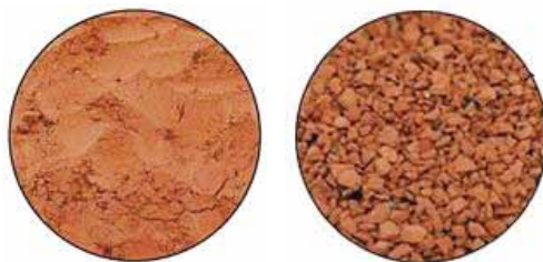
0.5ミリ以下の粉状のシャモットと、2～5ミリの粒状のシャモット。ほかの大きさのシャモットもある。
