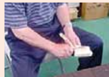
⑪櫛入れ 接着剤をさした後、金櫛をいれて毛の中に留まっているケバを取り出したり、毛クセを直したりして完全に抜けないようにする
