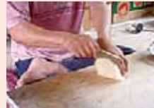
⑤毛揃え 灰もみした毛を束にして揃え、金櫛をよくいれて毛を一定方向に揃える
