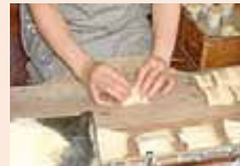
⑧紙巻き 毛を刷毛一本一本の目方で分け、それを紙で巻く
