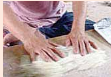
④灰もみ 火のし終了後、ワラ灰を使って毛を揉むことにより、毛の脂肪分を取り除き、塗料の含みを良くする
