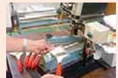
⑫包装 毛の部分にセロハンを巻いたり、木柄に刻印を打ったりする
