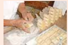
⑨板付け 紙巻きされた毛玉を木柄にはさみ、側面に桜紙を取り付ける
