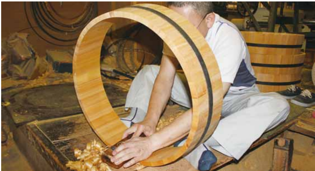
仮輪留めの状態。鉋をかけて、木目を生かした、なめらかな曲線をつくりあげる。
